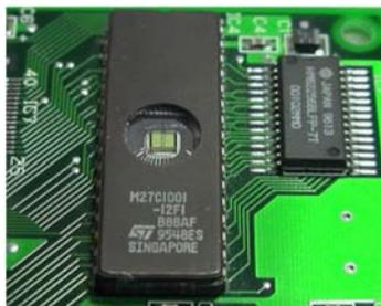
図16：プリント基板を用いた配線例（ROM，RAMの周辺配線）
