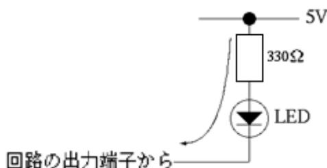
図 19 : LED による信号線の状態表示
